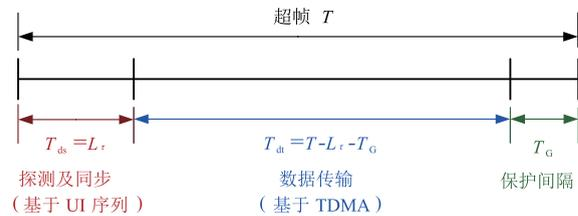
图2 UI-TDMA混合信道接入机制的超帧结构
