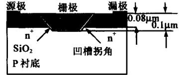
图1 槽栅器件结构剖面图
