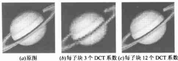
图 1 DCT 系数表征图像的作用比较
