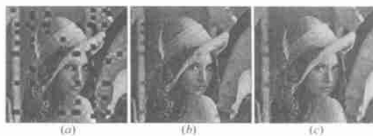
图 3 不同算法恢复的图像效果比较. (a) 不恢复; (b) 低频八邻域平均恢复; (c) WDIR 算法恢复
