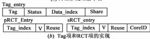
图1 CMP-VH的结构框图及实现
