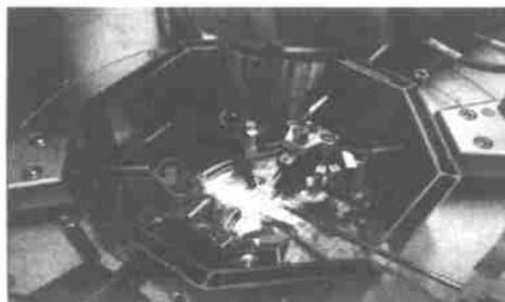
图 2 实验所用 Cascade<sup>TM</sup>芯片测试探针工作台, 内含 5 个 DC 探针和 2 个 RF 探针
