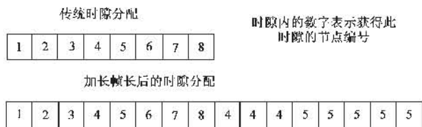
图2 第二个8节点网络的时隙分配示意
