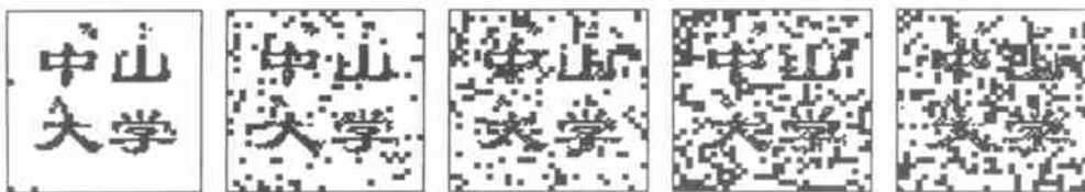
图 7 JPEG 压缩后水印提取图,从左到右分别对应压缩因子 90 %, 80 %, 70 %, 60 %, 50 %
