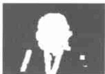
图 1 只根据某两帧图像的差值进行检测的结果 (noise)
