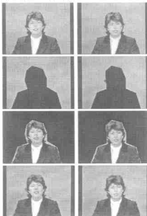
图 8 MPEG4 编码结果. 第 1 列: 第 13 帧; 第 2 列: 第 21 帧; 第 1 行: 原图像; 第 2 行: 重建的背景对象; 第 3 行: 重建的头肩对象; 第 4 行: 经对象编辑后重建的帧
