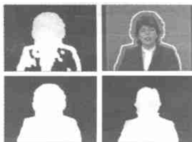
图 2 对象分割的过程. 左上: 检测后得到的模板; 右上: 模板边界包围对象; 左下: 预分割后得到的二值图; 右下: 腐蚀后的二值图
