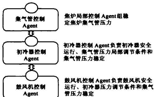
图 2 焦炉集气管压力、初冷器前压力和鼓风机前压力三级协调体系
