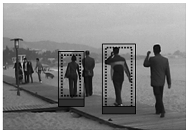
图2 训练样本的标注;图中虚线矩形框为包含行人的最小矩形窗口,训练时向下延伸窗口(图中的蓝色部分)有助于提高检测性能。注:照片来源于厦门大学数据库
