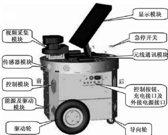
图1 电力巡检智能机器人
