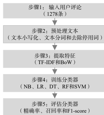
图2 使用机器学习算法进行非功能需求自动分类的过程
