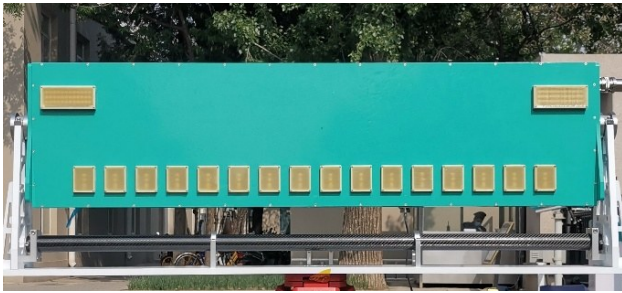
图4 16发16收地基MIMO雷达系统
