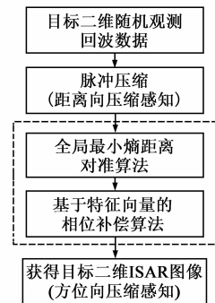
图3 ISAR二维压缩感知成像算法总体流程图
