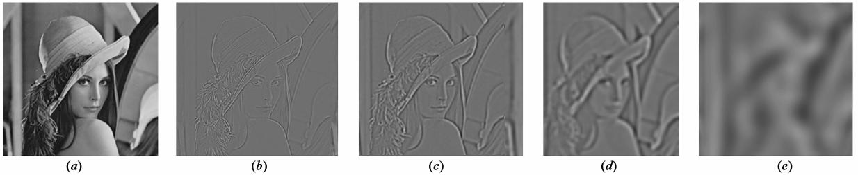
图1 快速经验模式分解完整效果,分解时间为0.093588S;(a)为原图;(b)(c)(d)(e)分别为快速经验模式分解的1-3层imf及剩余量
