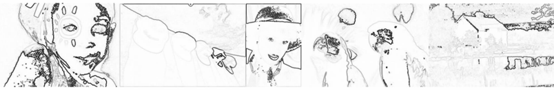
(b) 利用索贝尔算子直接计算色调分量得到的边缘图像
