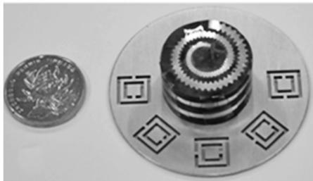
(b) 5个CSRR环的PEC反射板
