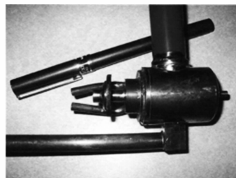
图4 CCR平面阵列金属柱慢波结构及600GHz~700GHz BWO样管
