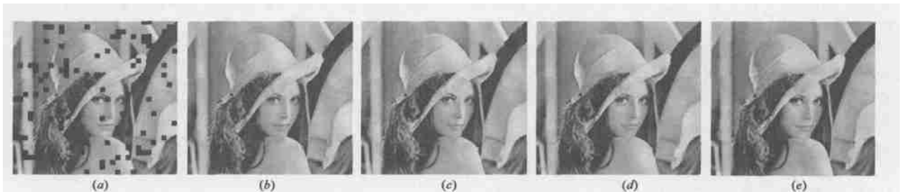
(a) 块丢失率为 10% 的图像, PSNR= 361.02dB; (b) 直接映射恢复的图像, PSNR= 781.56dB; (c) 一阶多项式映射恢复的图像, PSNR= 771.83dB; (d) 直接一阶混合映射恢复的图像, PSNR= 801.75dB; (e) 原始图像
