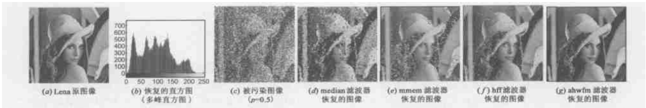
图 7 输入是 lena 图像,被污染概率 p = 0.5 时,不同的滤波器恢复的效果比较。
