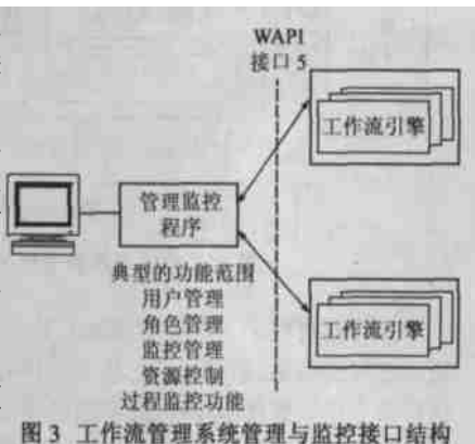
图 3 workflow 管理系统管理与监控接口结构
