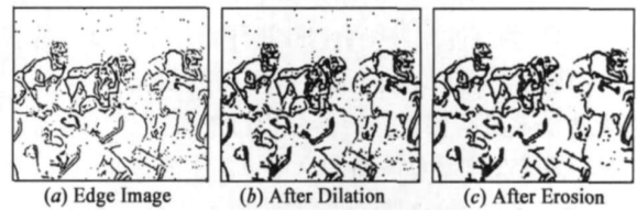
图4 在边缘图上进行形态学闭运算。(a) 原始图像; (b) 在(a)上膨胀后的边缘图; (c) 在(b)上腐蚀的边缘图
