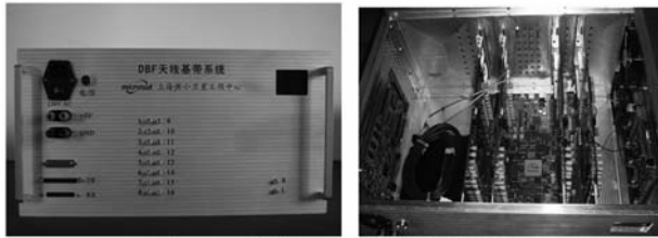
图6 DBF基带机箱外形和内部结构图
