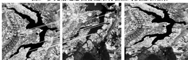
图 3 Landsat TM band 4 与 SPOT band 3 多传感器图像配准特征点对及配准结果
