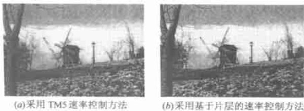
图 6 采用不同方法编码的 Garden 图像序列第 3 帧解码对比图 图 6 给出了 Garden 图像序列采用 TM5 速率控制方法及采用基于片层的速率控制方法进行编码后解码的某帧图像对
