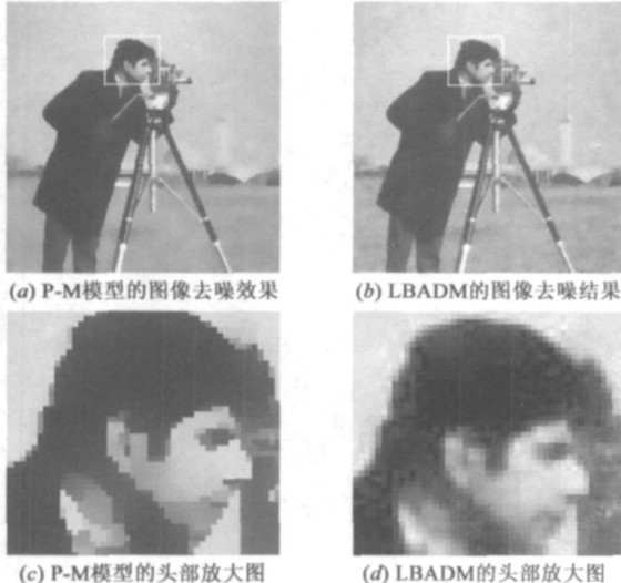
图 6 P-M 模型存在着一定的图像灰度的“阶越”现象
