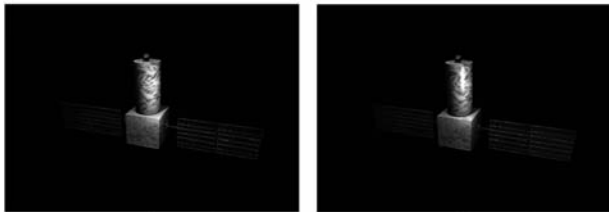
图3 Lambert模型和微面元模型绘制效果对比
