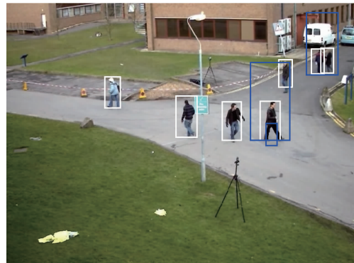
图2 真实场景中目标检测器输出观测结果示例图
