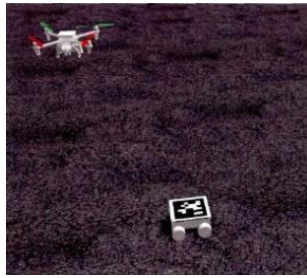
图5 无人机车载动平台着陆 [42]
