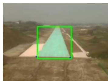
图4 固定翼无人机着陆跑道检测 [27]
