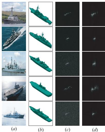
图 4 五类 SAR 三维转动舰船目标仿真示例 (a) 五类舰船目标光学图像; (b) 3D 模型; (c) 静止状态; (d) 三维转动状态
