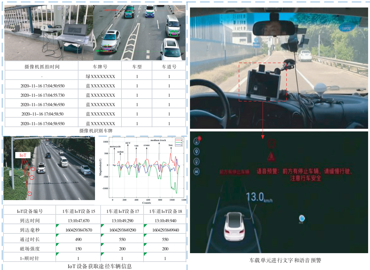
图4 初级虚拟车道技术用于避免车辆碰撞的实验结果
