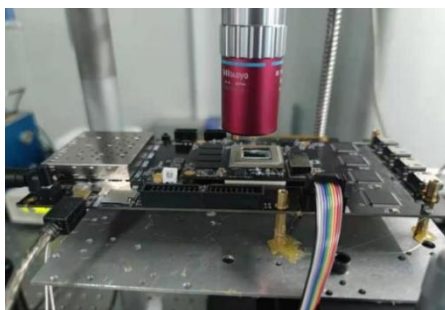
图7 激光故障注入装置实物图
