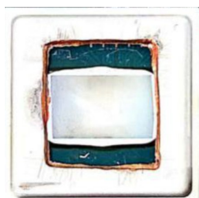
图2 Kintex-7系列FPGA背部开封装图
