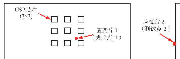
图6 应变片放置位置示意图
