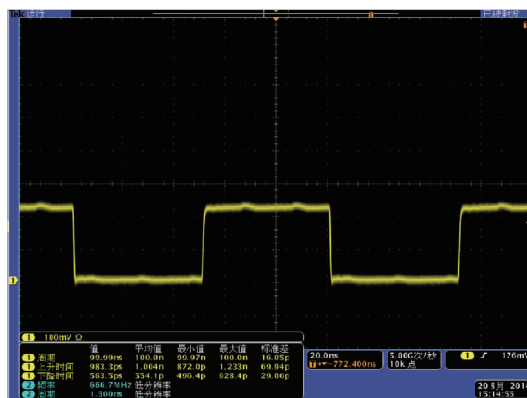
图8 10 MHz信号典型示波器采样
