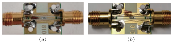
图10 加工测试实物图 (a) 电感双端口参数测试; (b) 电感旁路特性测试
