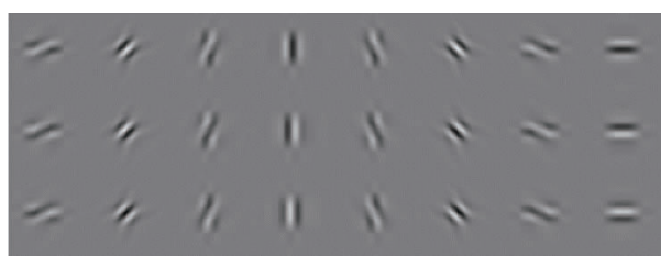
图2 互补色小波CCWT对应的经典小波,每列对应 n=k\pi/8, k=1, 2, \dots, 8 中的一个方向,每行对应 \theta=0, 2\pi/3, 4\pi/3 中的一种相位
