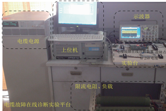
图12 电缆故障在线诊断实验平台
