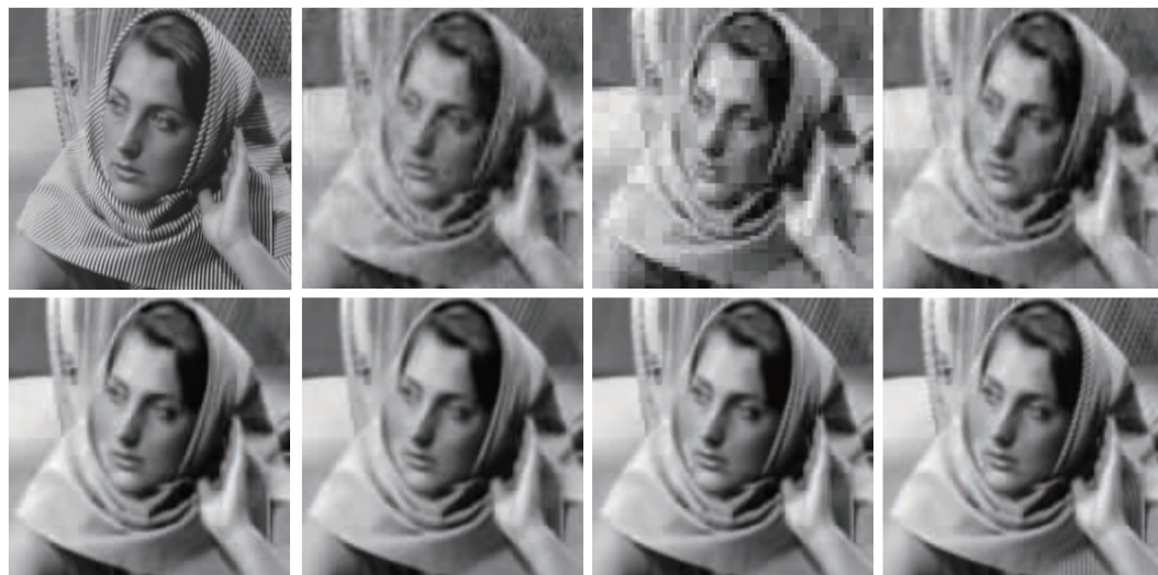
图10 20%采样率下各种算法重构的Barbara图像,自上到下从左到右分别为原图、AMP(27.38dB)、Turbo-AMP(25.61dB)、WaTMRI(28.21dB)、BM3D-CS(29.97dB)、NLR-CS(29.55dB)、BM3D-AMP(30.71dB)和本文算法(31.84dB)的重构图像
