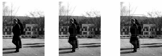
(a) 原图 (b) 可变部件的可视化分布 (c) 双人目标的最终检测结果
