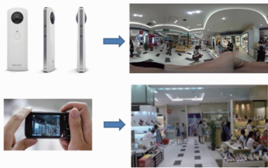
图1 使用的全景设备及图像(用于重构)和平面设备及图像(用于定位)
