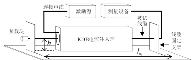
图 2 基于 IC3B 注入环的 kA 级 PCI 电路建模研究平台
