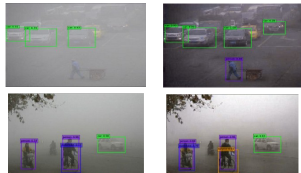
(a) 雾霾图像目标检测结果 (b) 去雾图像目标检测结果
