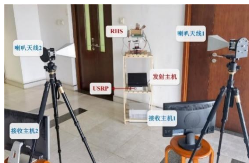
图11 RHS辅助下的通信平台测试场景图
