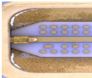
图 17 调试小岛压接实物图
