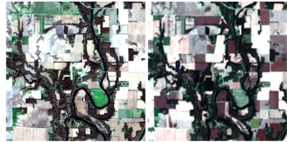
(a) 多光谱图像的伪彩色图像(波段 3, 2, 1) (b) 高光谱图像的伪彩色图像(波段 20, 5, 3)
