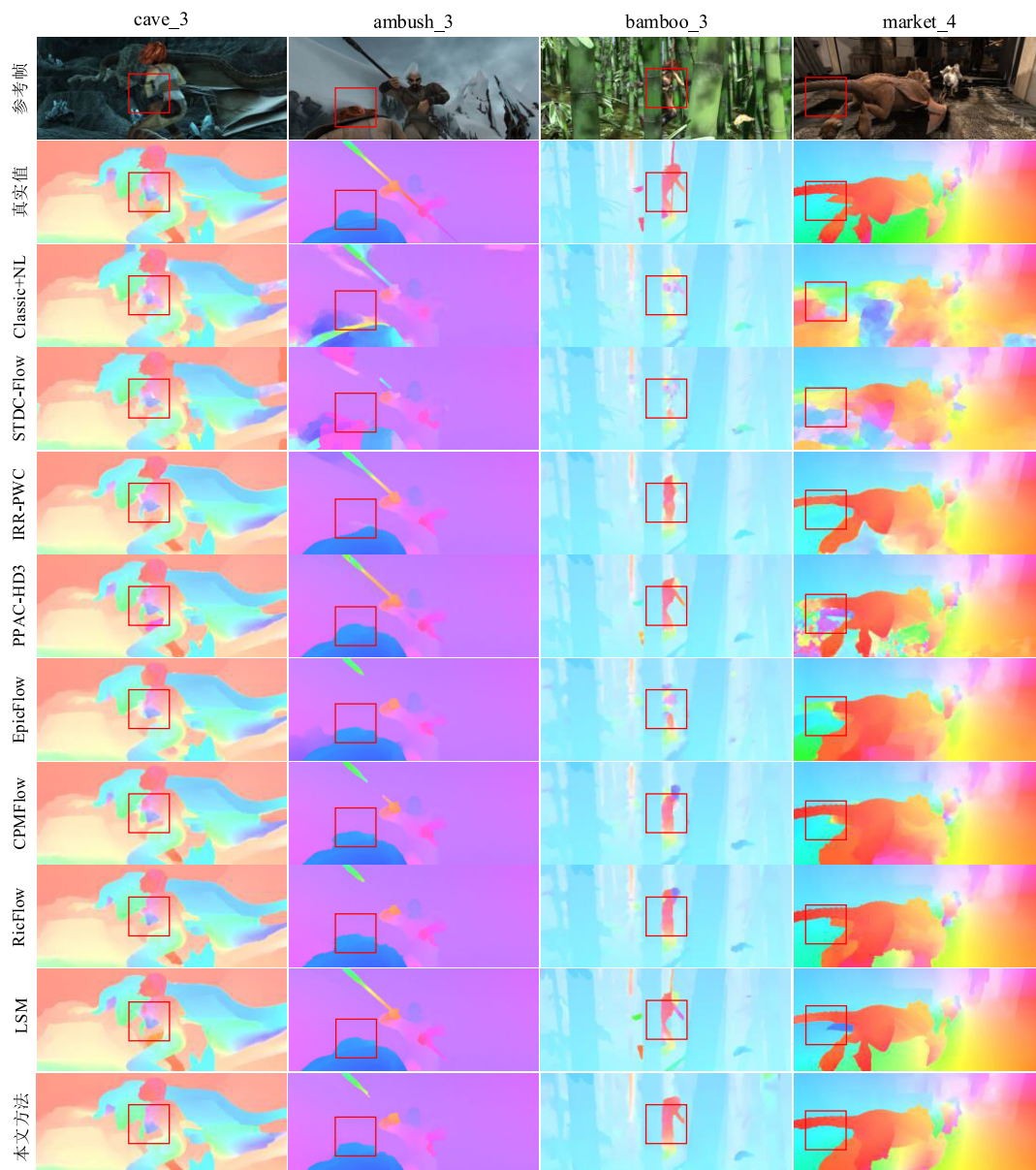
图5 MPI-Sintel数据集大位移运动与遮挡图像序列光流估计结果
