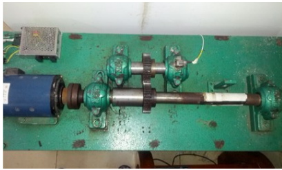
图 14 齿轮-滚动轴承复合故障模拟实验台
