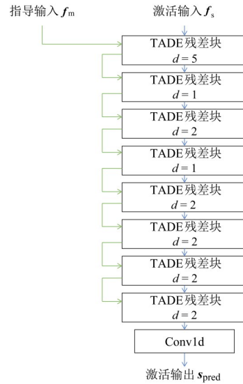
图8 所提方法的神经声码器结构
