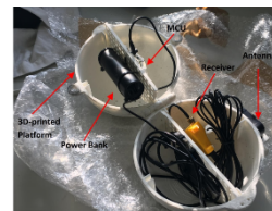
(b) 双GPS系统定位标校器内部结构示意图
